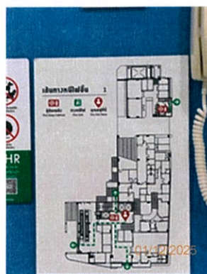
ภาพถ่ายที่ 2.2-70 แผนผังแสดงตำแหน่งหนีไฟและอุปกรณ์ป้องกันอัคคีภัยบริเวณโถงลิฟท์
